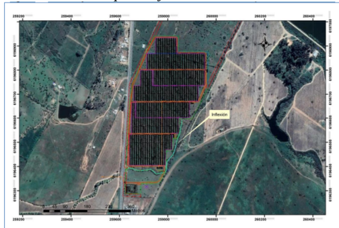
Figura 18. Sector bajo del terreno o inflexión libre de instalación de paneles fotovoltaicos.
