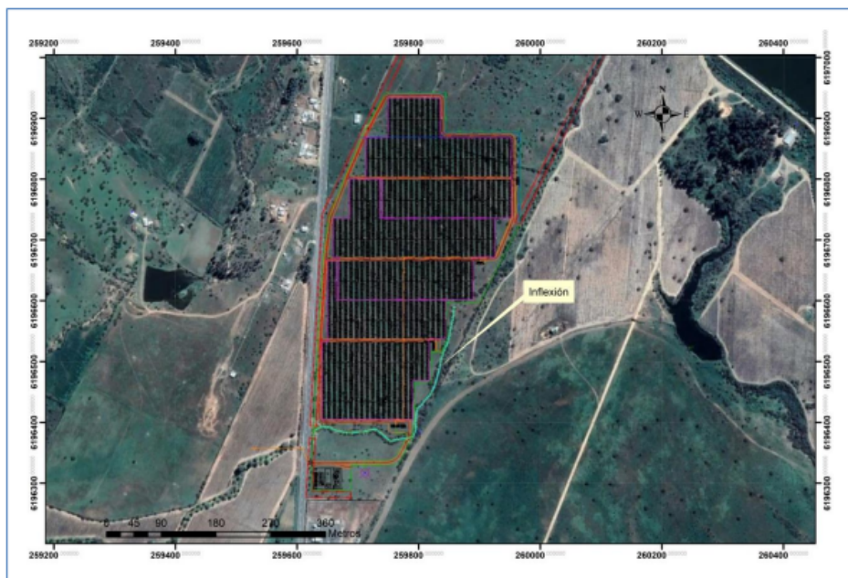
Figura 10. Sector bajo del terreno o inflexión libre de instalación de paneles fotovoltaicos.
