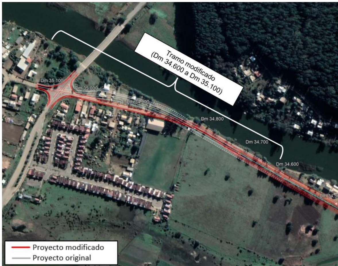
Figura 1: Modificación del Eje del Trazado entre Dm 34.600 y Dm 35.100
