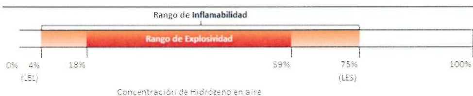
Figura 23. Rango de inflamabilidad y explosividad del hidrógeno en aire
