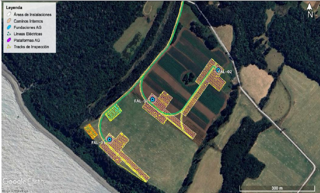
Figura 12: Tracks de inspección (líneas en tono amarillo) en las áreas donde se planifican las obras del proyecto (se debe considerar que el aerogenerador FAL-01 fue eliminado)
