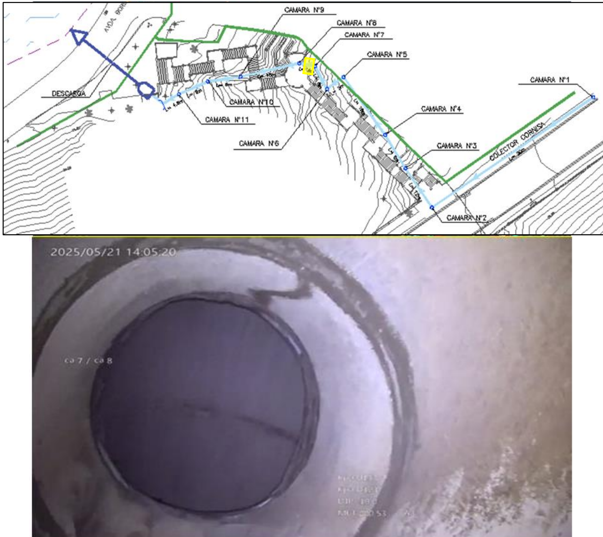
Figura 2-9 Colector Cornisa. Cámaras N°7 (CO-00-017B) y N°8 (CO-00-017C)
