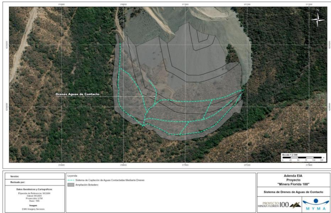
Figura 5: Sistema de drenes – Ampliación Botadero de Estériles
