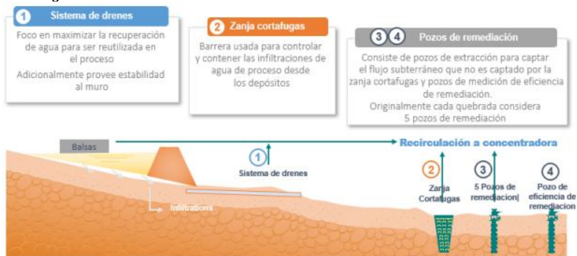
Figura 1-4: Sistema de control de infiltraciones.
