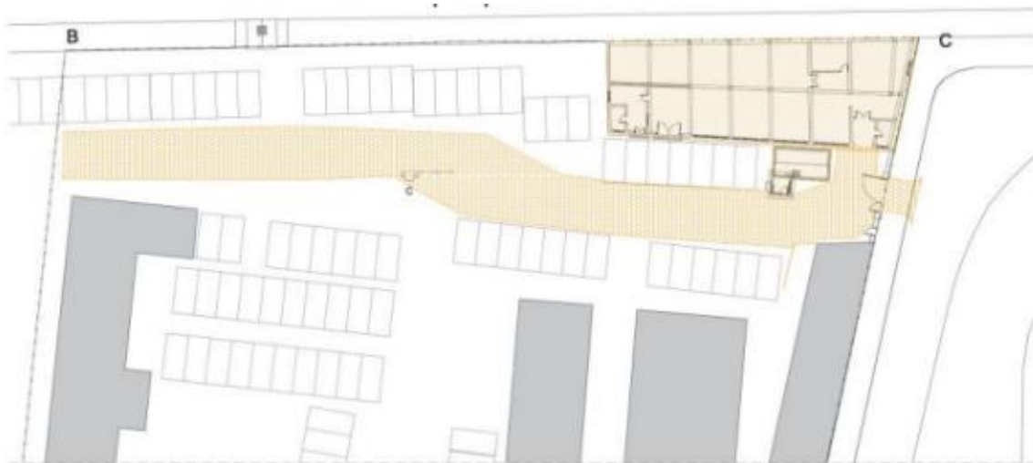
Figura 34. Edificación a demoler y pavimento de adoquines a retirar en el área del MH Hospital San José.
