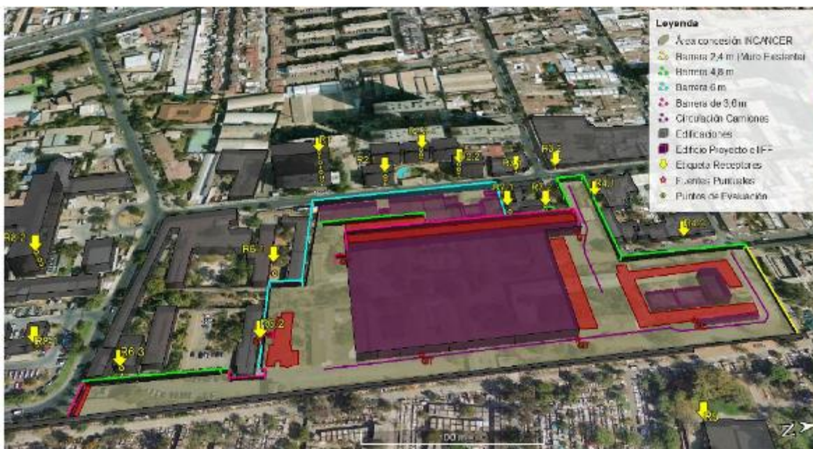
Figura 8. Esquema General de Ubicación Barreras Acústicas – Escenario 2 (Obra Gruesa).
