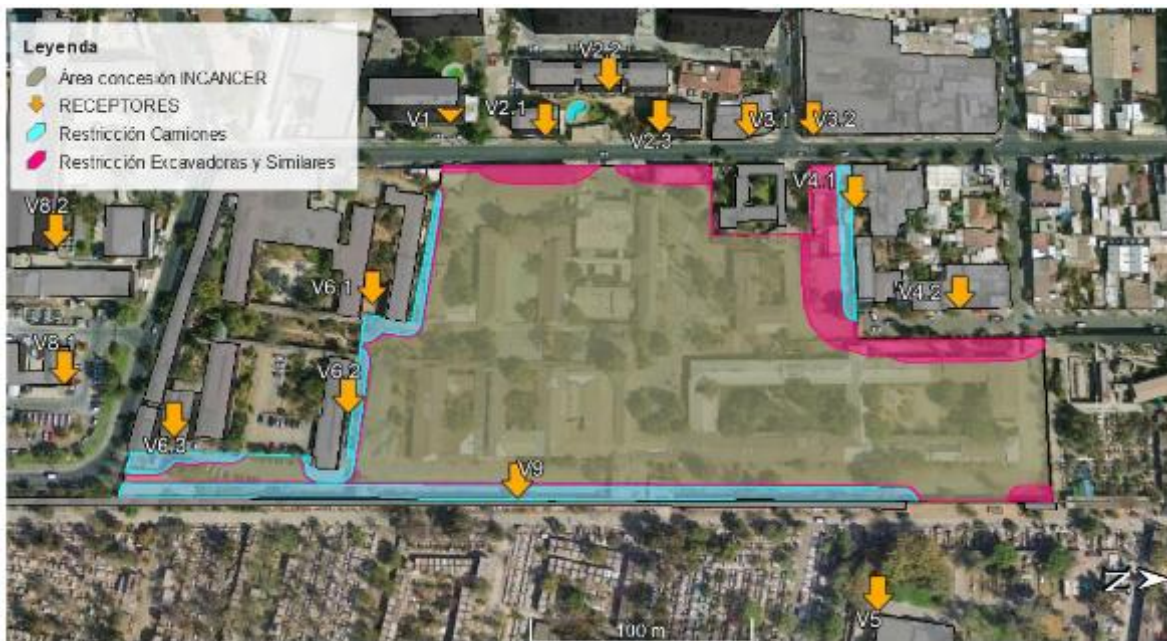
Figura 15. Medidas de Control de Vibraciones.
