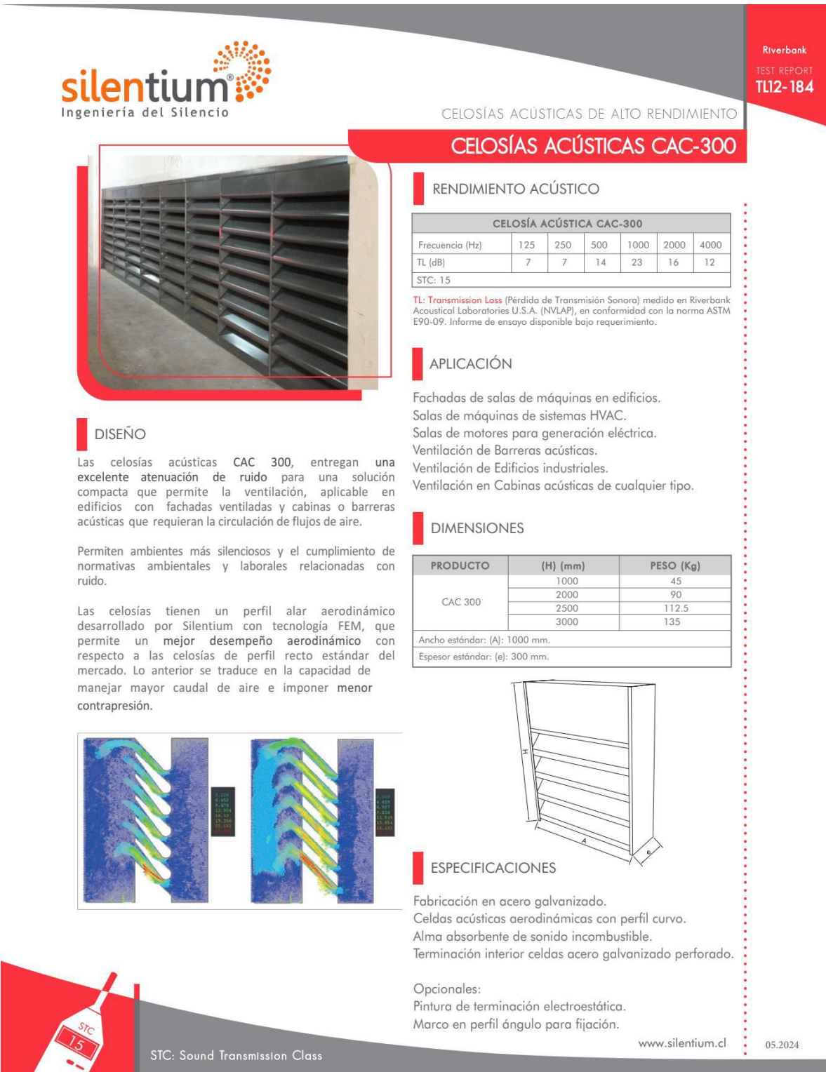
Figura. 11.Ficha técnica Referencial de Celosías Acústicas.
